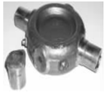
图 1 某一十字销断口形貌
